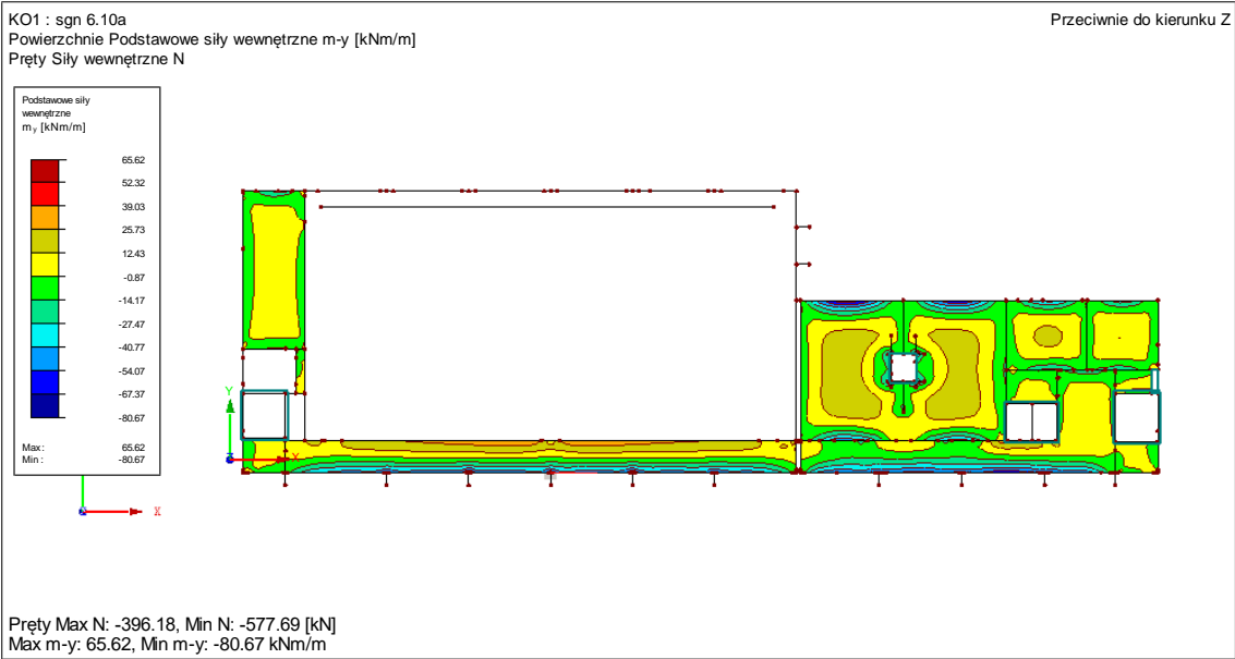
Rys. nr 7. Płyta zero – momenty zginające My
